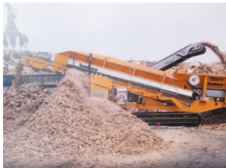
◀ Absiebung von Altholz nach vorgeschaltetem grobem Brecher
