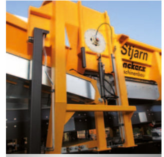
Dosierschnecke, hydr. verstellb.
