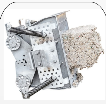
Doppelklappe für gleichmässige Auspressung des Presskuchen.
